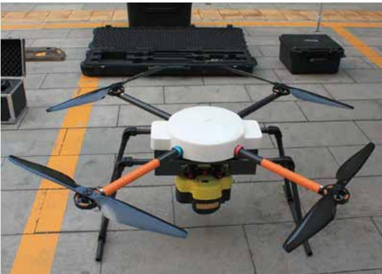
中遥 H4 型多轴旋翼无人机
